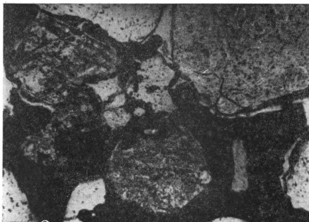
Фиг. 1. Выделения твердого битума (черное) в графелите; в проходящем свете, увел. 30, без анализатора
