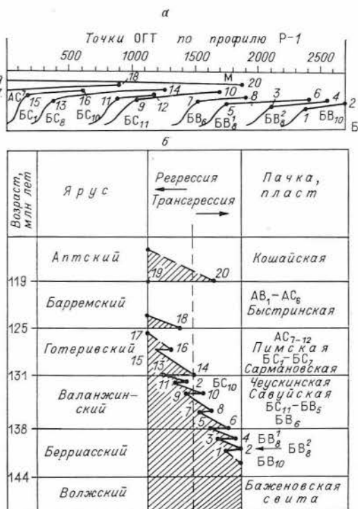
Рис. 6. Сейсмоциклостратиграфическая схема неокома по региональному сейсмическому профилю Р-1 (Широтное Приобье).
