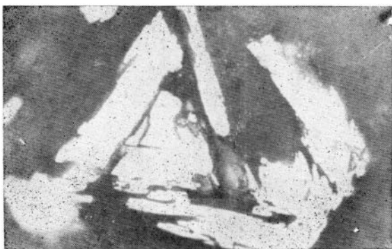
Рис. 4. Реликты перекристаллизованного скелетного кристалла магнетита из серпентин-магнетитовой руды. Полир. шл. Иммерсия. Увел. 1300.
