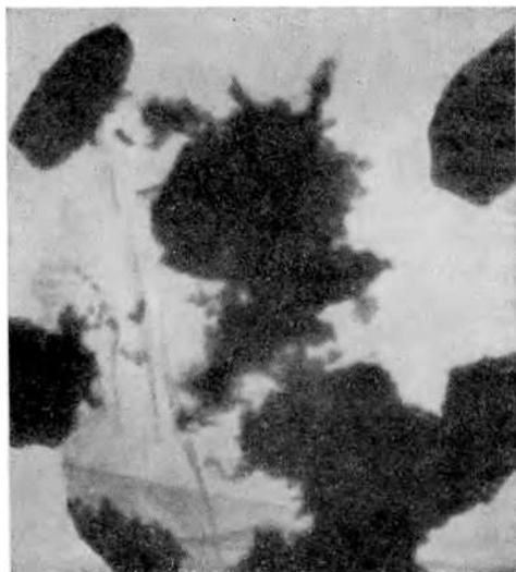
Рис. 34. Снимок в электронном микроскопе фракции  $< 0,001$  мм лёссовой породы из района г. Запорожья.  $\times 40\ 000$
