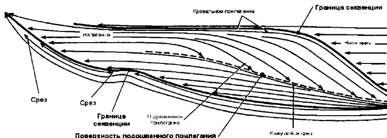
Рис. 31. Схематическое изображение секвенции и различных видов соотношений сейсмических горизонтов в ее пределах (по П. Вейлу и др.)
