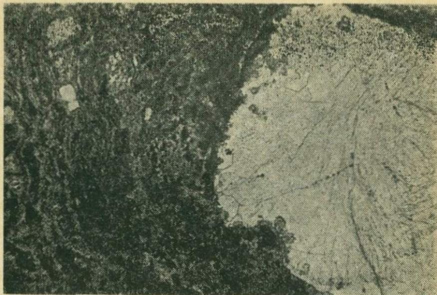
Рис 12. Вкрапленники кальцита (светлые) с зональными кристаллами кристобалита в эфузиве. Увел. 32×. Николи +.
