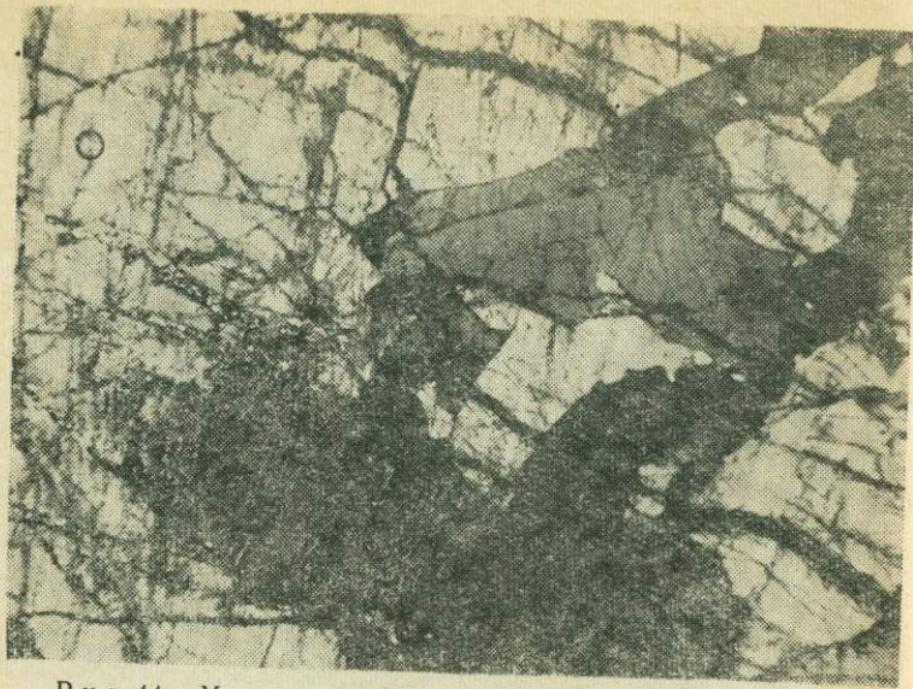
Рис. 44. Метакристы эпидота «решетчатого» внутреннего строения в измененном плагиоклазе (светлое). Серые зерна-кварц. Увел. 32×. Николи+.
