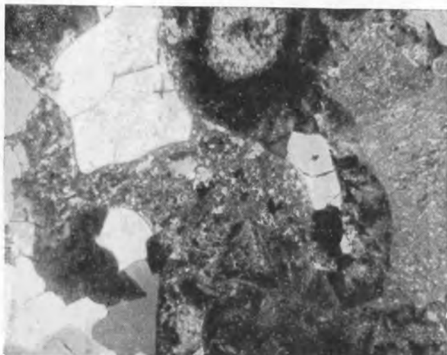
Фиг.30. Новообразования кварца и калишпата по гранит-порфирам (видны реликты мелкозернистой массы гранит-порфиров). Увел. 20, с анализатором
