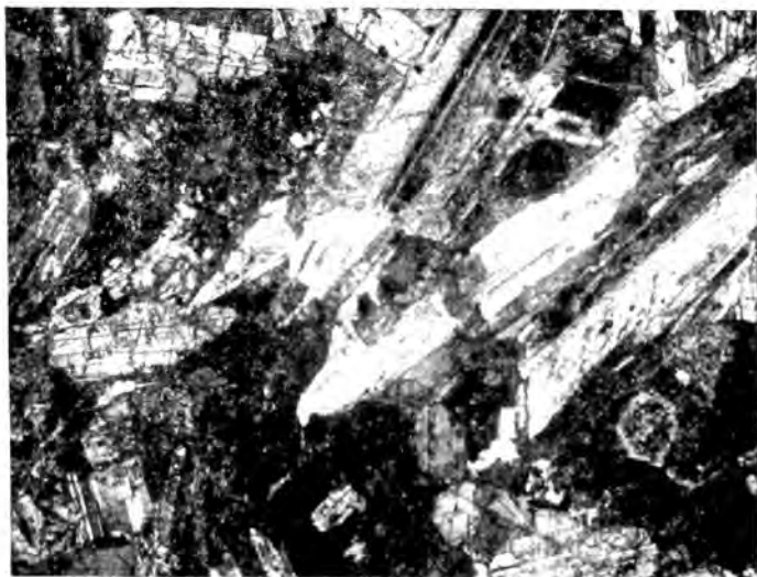
Фиг. 25. Габбро Николаевского массива. Увел. 10, с анализатором
