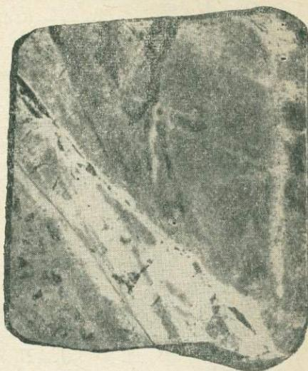
Рис. 61. Пироксен-плагиоклазовый роговик (темное), вдоль трещин превращенный в альбит-актинолитовый роговик (светлое). Скв. 932, гл. 613 м.
