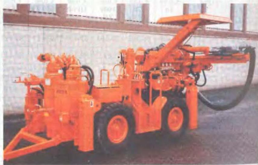
Рис. 2.27. Буровая установка фирмы "SANDVIK TAMROCK" для бурения глубоких скважин
