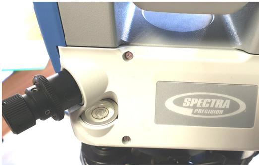
*Рис. 2.5.* Круглый уровень тахеометра
