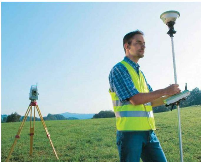
*Рис. 2.14.* GNSS-приёмник, установленный на телескопическую вежу и удерживаемый вручную по круглому уровню
