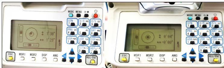
*Рис. 2.7.* Электронные уровни тахеометров
