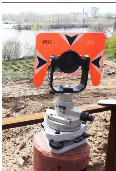
*Рис. 2.8.* Призменный отражатель, установленный через адаптер на трегер, устанавливаемый на базовой точке
