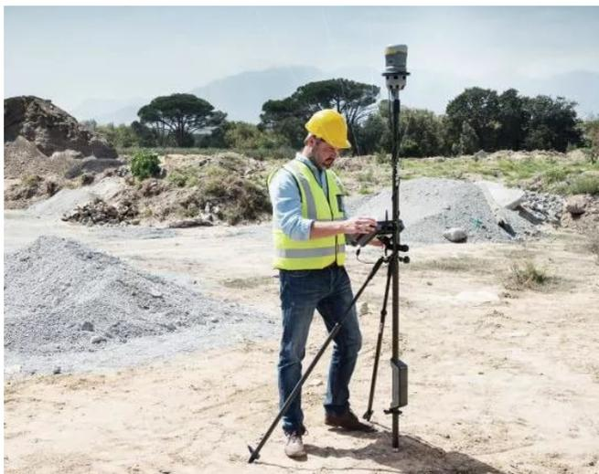
*Рис. 2.12.* GNSS-приёмник, установленный на телескопическую вежу в комплекте с биподом
