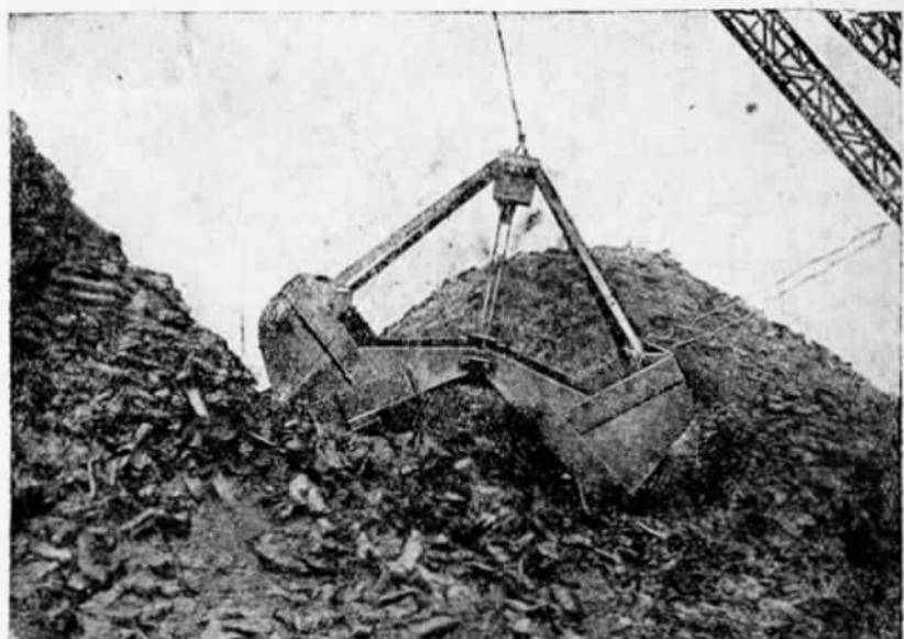
Фиг. 47. Захват торфа грейфером.
