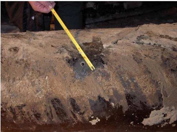
**Рис. 4.9.** Внешний вид участка трубопровода, пораженного коррозией под действием серооксилирующих бактерий
