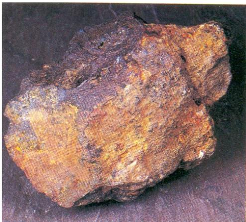
**Рис. 2.3. Железная руда магнитный железняк – смесь оксидов железа ( $\text{FeO}$ ,  $\text{Fe}_2\text{O}_3$ ,  $\text{Fe}_3\text{O}_4$ )**
