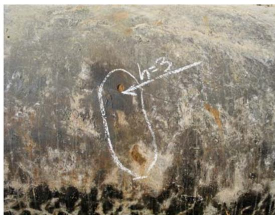
**Рис. 3.11. Питтинговая коррозия на поверхности трубопровода**
