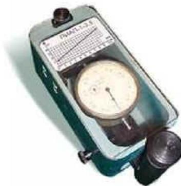
**Рис. 6.5. Адгезиметр АС-1 для оценки адгезии покрытий на основе битумов**
