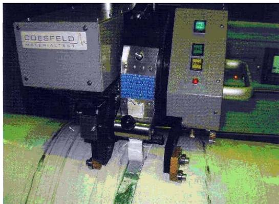
**Рис. 6.4. Определение адгезии полимерной ленты к поверхности трубопровода**
