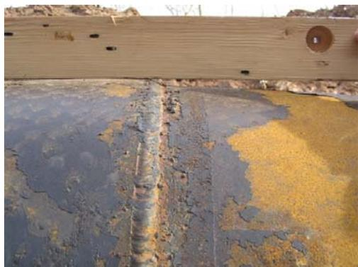
**Рис. 1.1. Общая коррозия на поверхности трубопровода на участке разрушенной изоляции**
