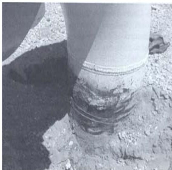
**Рис. 4.5. Коррозия трубопровода на границе раздела грунт/воздух [62]**
