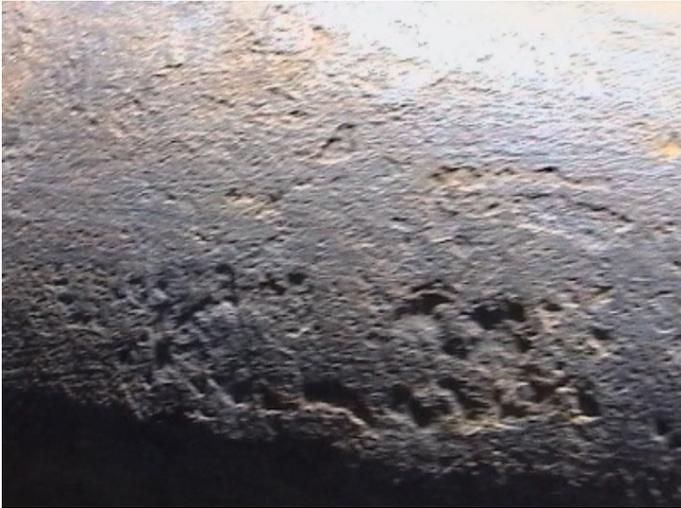
**Рис. 1.3. Язвенная коррозия на участке трубопровода**
