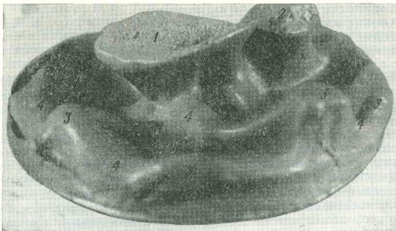
Рис. 20. Кольцевое расположение куполов вокруг ваннообразных вдавленностей в рельефе поверхности каучука. (Модель 88 со снятой замазкой)
