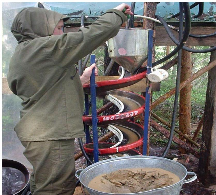
Рис. 74. Дополнительное обогащение мелкообломочного материала на винтовом шлюзе
