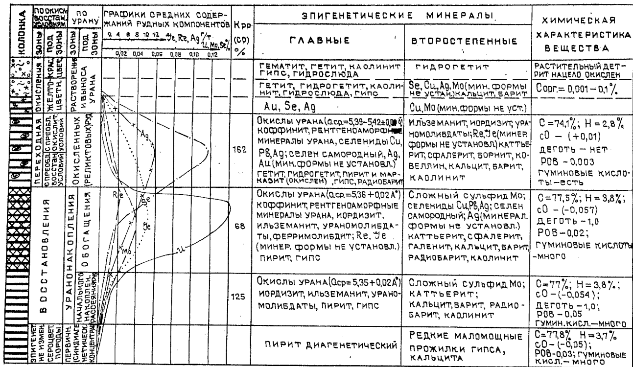
Рис. 43. Рудоконтролирующая минералого-геохимическая зональность на Нижнеильском месторождении (по В. Г. Белозерову и М. Ф. Каширицевой): 1 — конгломераты, песчаники, алевролиты, глины; 2 — уголь (а — с пятнами лимонитизации); 3 — подзона окисления красноцветная; 4 — то же, желтоцветная; 5 — степень окисленности органического вещества; 6 — растворимое органическое вещество; 7 — урановое оруденение
