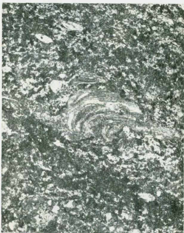
Рис. 15. Включения сплоенных сланцев в массивной руде. Иртышское и Белоусовское месторождения. Шлиф. Ув. 90.
