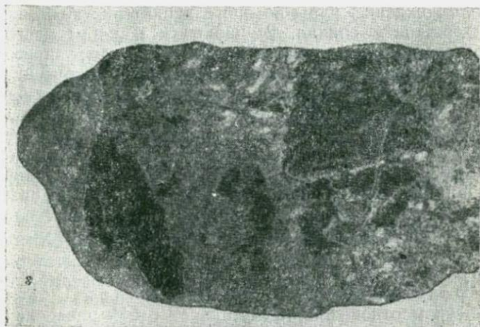
Рис. 8. Обломки тонкозернистых полиметаллических руд в сплошной колчеданий руде. Корбалихинское месторождение. Образец. Ув. 1,5.
