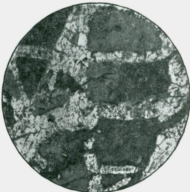
Рис. 24. Пересекающиеся жилы скелетного пирита в полиметаллической руде. Корбалихинское месторождение. Шлиф. Ув. 90.
