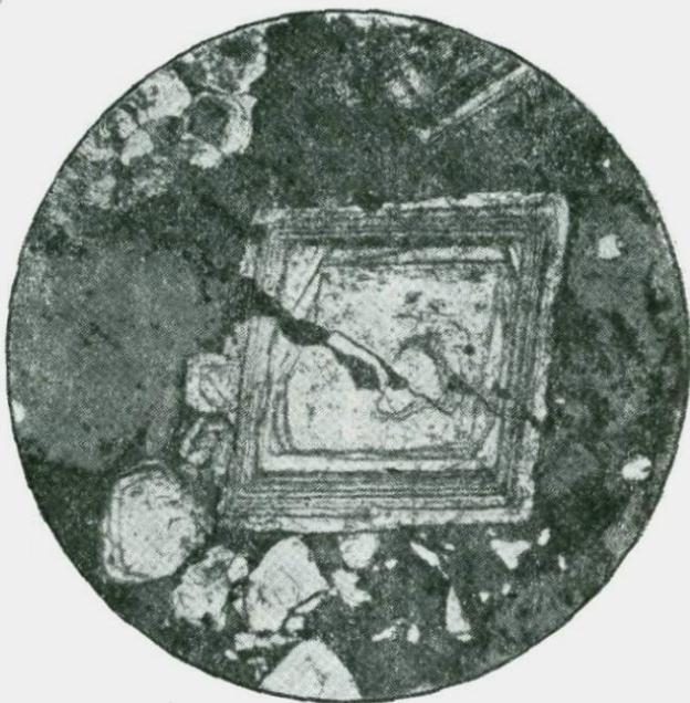
Рис. 23. Кристаллы зонального пирита с четкими границами с полиметаллической рудой. Орловское месторождение. Шлиф, Ув. 90.
