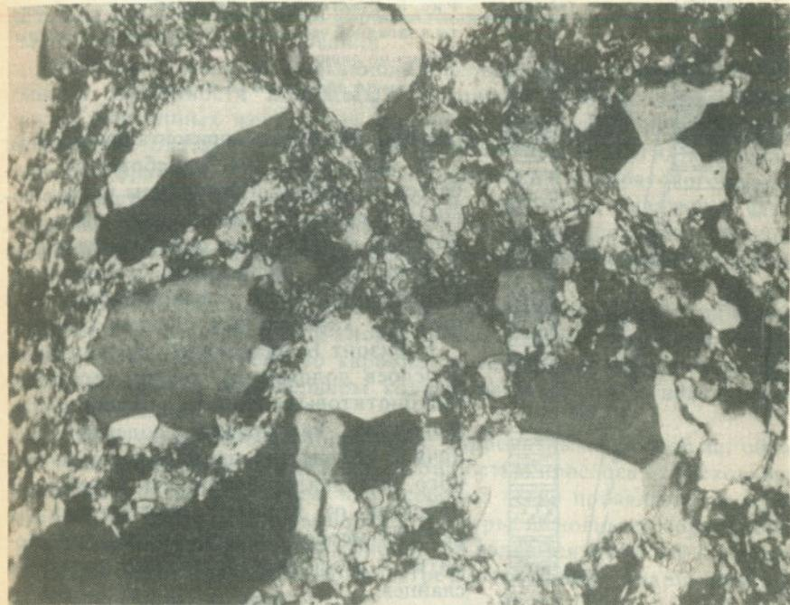
Рис. 5. Полимиктовый песчаник роговской свиты. Округлые обломки кварца и полевых шпатов заключены в серицит-карбонатный цемент.
