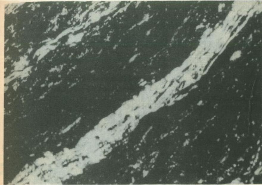
Рис. 8. Двуслюдянный углеродистый сланец. Тимская свита. Тонкодисперсное углеродистое вещество равномерно рассеяно в породе.
