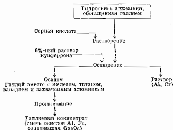
Рис. 99. Технологическая схема получения галлиевого концентрата по купферроному способу (По П. А. Резник и З. В. Мироновой)
