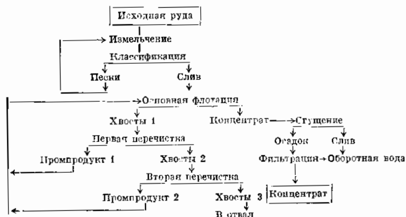
Рис. 109. Принципиальная схема флотационного процесса обогащения ртутных руд (по С. М. Мельникову)
