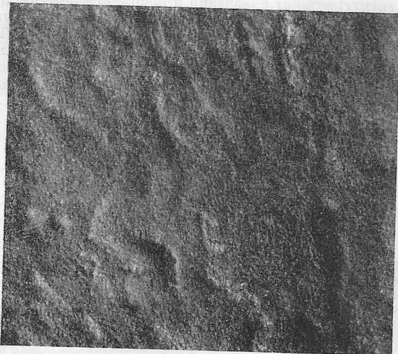
Фиг. 3. Тот же метеорит. Бородавчатая структура коры плавления на тыловой поверхности.  $\times 7$ .
