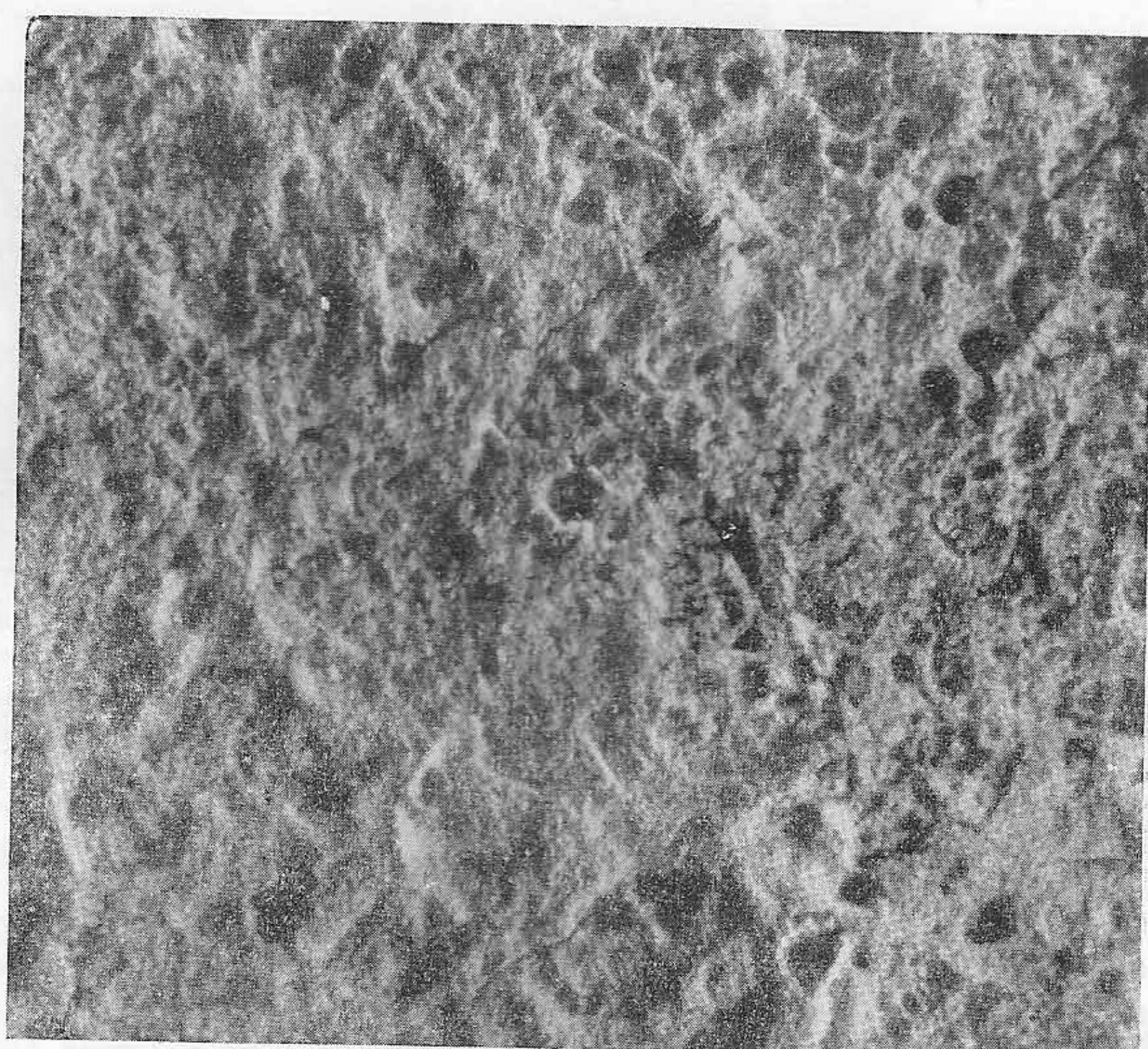
Фиг. 20. Шлакообразная структура коры плавления на тыловой поверхности четвертого обломка каменного метеорита Еленовка.  $\times 8$ .
