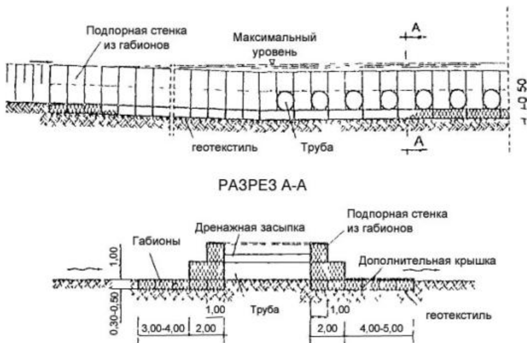
Рис. 7.2 Схема устройства многоступенчатых габионных перепадов в нижнем бьефе переливаемых насыпей и сооружений.
