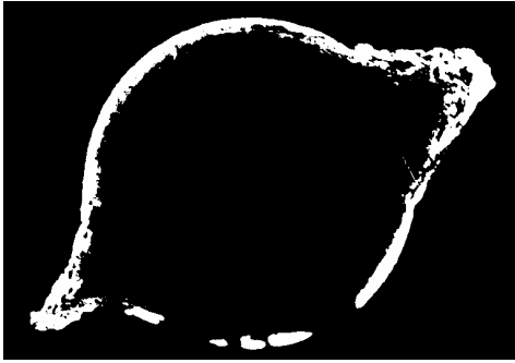
Рис. 1.63. Фотография скважины, разрушающейся под действием высоких напряжений.
