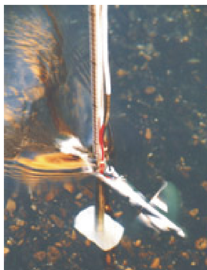
Рис. 12. Пропеллер вертушки С31
