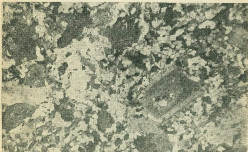
Рис. 11. Диоритовый порфирит с зональными включениями плагиоклаза. Шл. 4832, уступ 4 Эмельджакского флогопитового месторождения, Алдан. \times 40 , П+.
