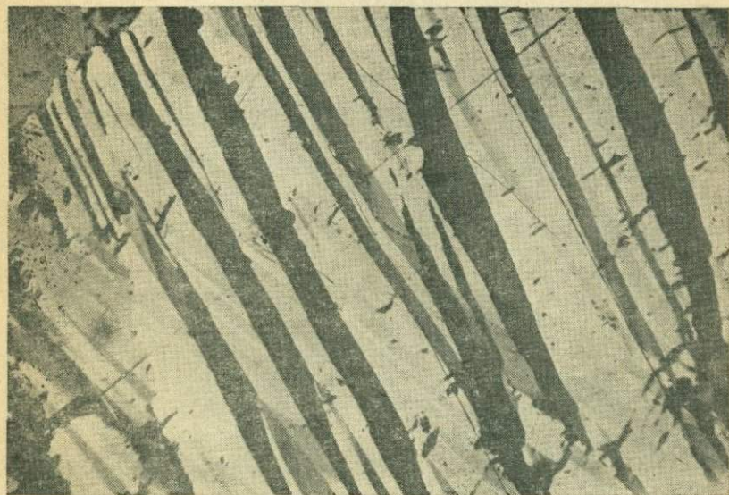
Рис. 15. Система разноориентированных двойников давления в крупных кристаллах антимонита. Начальная стадия динамометаморфизма. Месторождение Сарылах, Восточная Якутия. \times 90 , П \times (угол 20°). Снято четвертым способом, МИМ-8, объектив 3,7 \times , гомоль VI, пластинка «микро» 16 ед. ГОСТ, выдержка 35 с.
