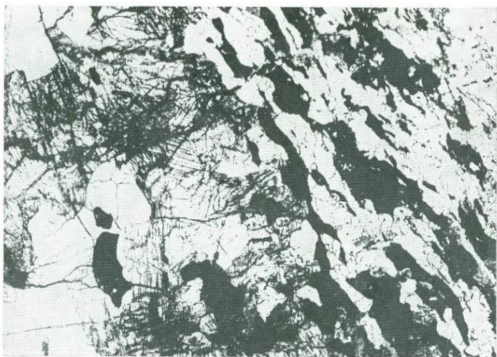
Фото 8. Обособление крупнозернистых двупироксеновых эвлизитов, рассеянных полосчатостью новообразованного магнетитового кварцита. Без анализатора. Увел. 7. Приазовье, Куксунгурский участок, скв. 76
