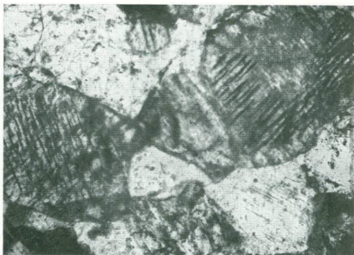
Фото 3. Зональные зерна клинопироксена из двупироксен-роговообманкового мафитового гранулита. Без анализатора. Увел. 30.
