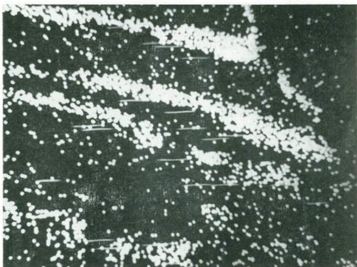
Фото 27. Распределение кальция в инвертированном ферропирожните. Электронный микроанализатор. Увел. 600. Ламелли клинопироксена, богатого кальцием, имеют тонкопластинчатую форму
