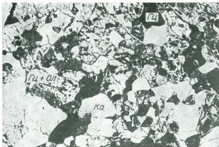
Фото 13. Метасоматическая ассоциация Гц+Ол+Ка, возникшая при карбонатизации гиперстен-роговообманкового мафитового гранулит. Темные зерна — герцинит; однородные прозрачные — кальцит. Между крупными зернами герцинита и кальцита развиты оливин-герцинитовые симплектиты. Без анализатора. Увел. 20. Верхнее Побужье, Винницкий участок
