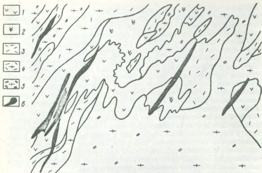
Рис. 4. Схема геологического строения Каменномогильского массива (Приазовье): 1 – лейкократовые гиперстен-плагноклазовые анортозитовые гранулиты; 2 – двупироксен- и гиперстен-роговообманковые мафиты; 3 – гнейсы и сланцы биотитовые, гранат-биотитовые; 4 – мигматиты биотитовые; 5 – плагногнейсы апоамфиболитовые; 6 – пегматитовые жилы
