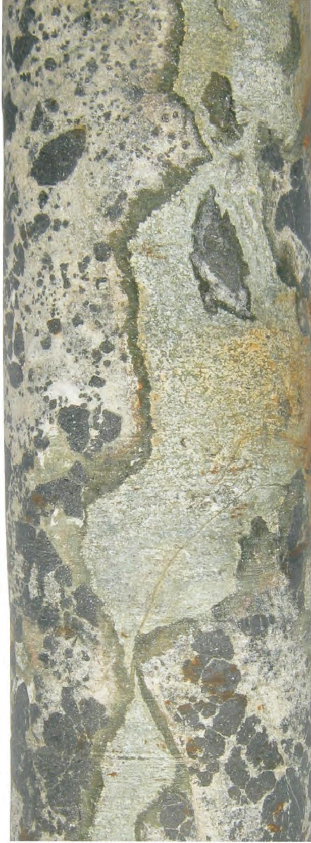
Фото 10. Дайка ювигов в апатит-форстерит-магнетитовой руде. Видны оторочки мелкошешуйчатого слюдита по силикатной части руды. Ковдор. Железородное м-ние. Скв. 42°, Ø керна 88 мм.
