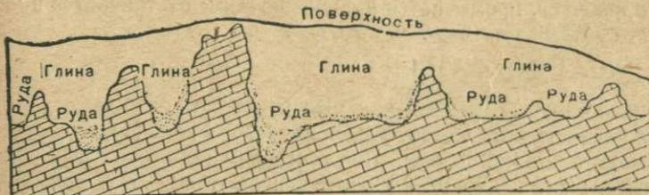
Рис. 46. Открытые разработки цинковых руд Bertha, Virginia, где видны соотношения остаточных руд к „трубам“ (chimney) известняка и остаточной глине (по T. L. Watson).
