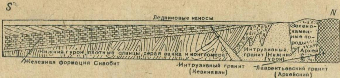
Рис. 51. Сводный разрез, показывающий отношение железной формации к вмещающим породам в толще хребта Mesabi (штат Minnesota) (по J. F. Wolff).
