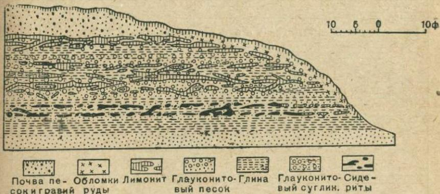
Рис. 36. Окисление углекислого железа в лимонит в третичной толще провинции Cass, Texas (по E. F. Burchard).
