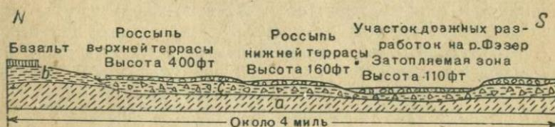
Рис. 7. Разрез по реке Feather ниже Oroville, Cal.
