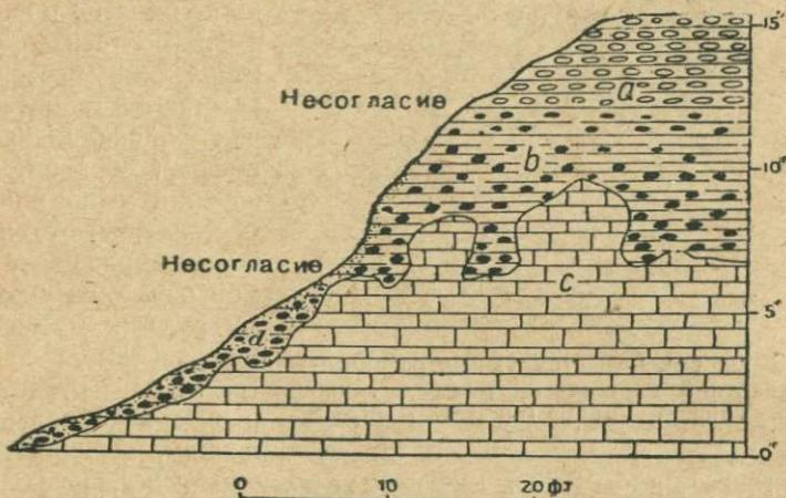
Рис. 42. Сводный геологический разрез месторождения марганцевых руд в Batesville, Arkansas.
