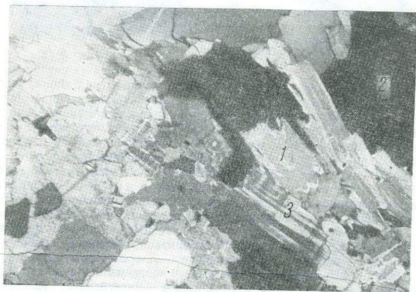
Рис. 34. Морфологические особенности биотита из контактовых зон пегматитовых тел в гранитоидах Каратюбе. Николи II, ув. ~30. 1 — биотит; 2 — кварц; 3 — микроклин.
