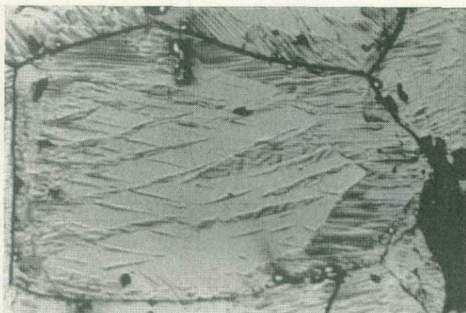
Рис. 2. Замещение гексагонального пирротина моноклинным вдоль трещин по краям зерна.
