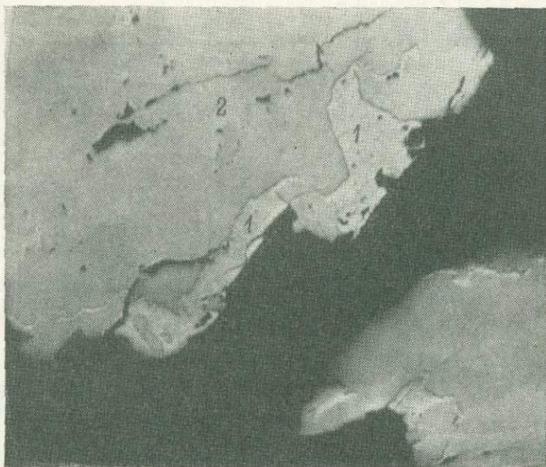
Рис. 2. Кайма и тонкие прожилки герсдорфита (1) в никелине (2). Полированный шлиф, скв. КЗ-105, гл. 222 м, увел. 165.
