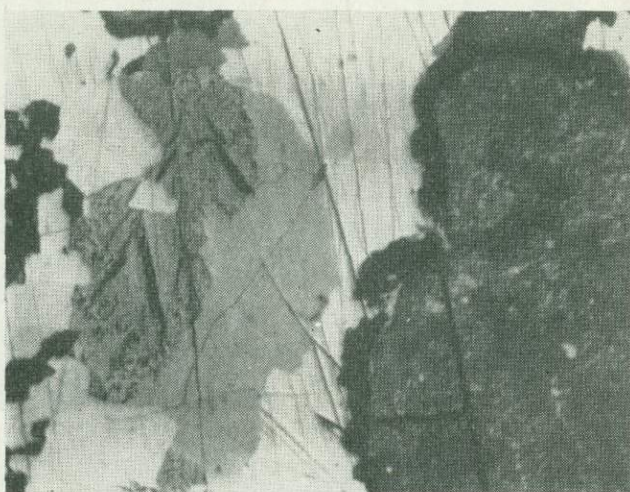
Рис. 5. Выделения сульфовисмутидов меди (слева, мирмекиты) и сульфовисмутидов меди и свинца (справа) в галените. Темно-серое — коффинит. Увел. 160.
