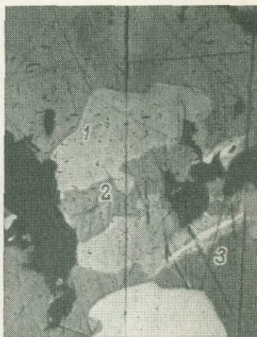
Рис. 4. Станноидит (1) с оторочкой моусонита (2) в массе борнита (3). Полированный шлиф, увел. 240.
