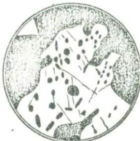
Рис. 13. Идиоморфная вкрапленность магнетита, приуроченная к трещинам спайности в зернах амфиболов (Побужье, обр. 18502/200; черное – магнетит, белое – амфиболы).
