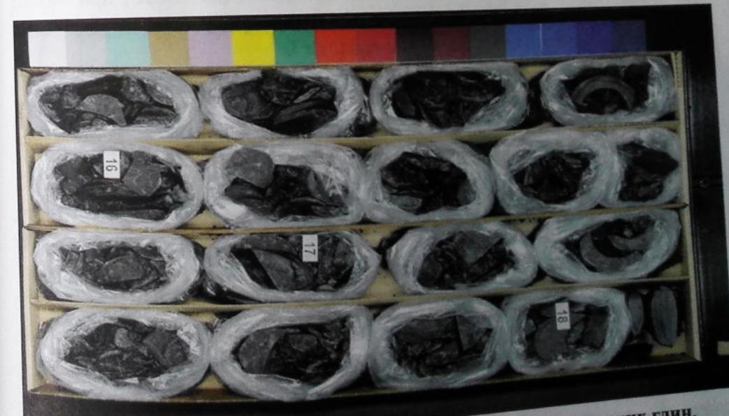
Рисунок 14 – Внешний вид керна из интервала покачевских глин.
