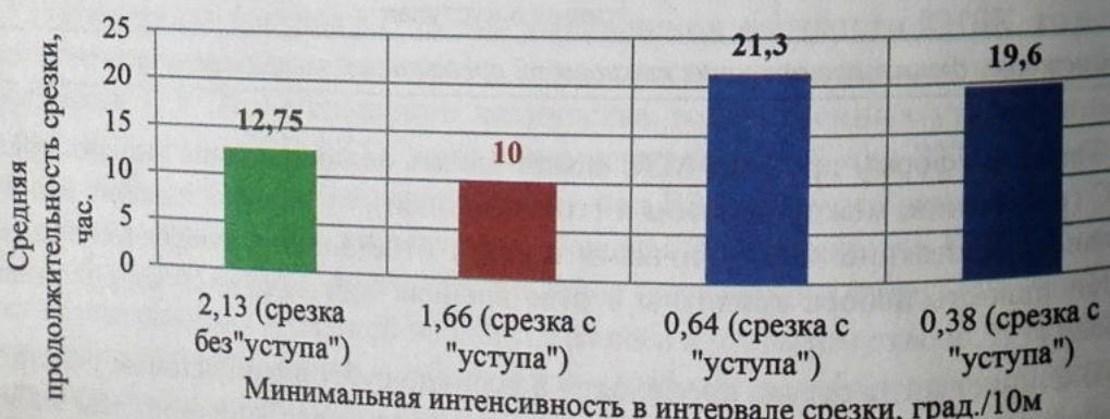
Рисунок 4 – Влияние минимальной интенсивности кривизны на продолжительность срезки в МЗС (пласт AB1-2).
