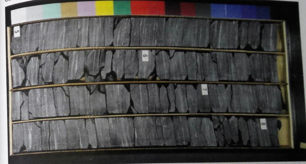
Рисунок 13 – Внешний вид керна из интервала кошайских глин.
