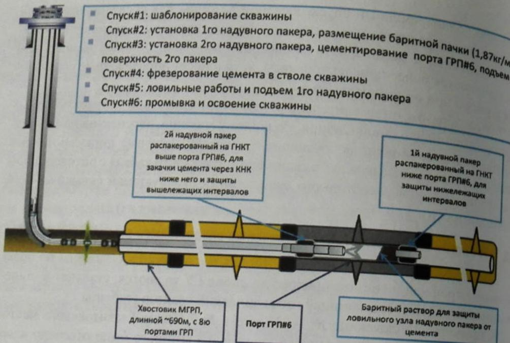
Рисунок 5 – Стадии работ по водоизоляции интервала.
