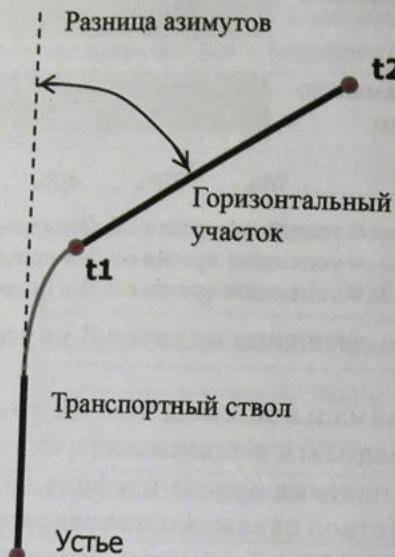
Рисунок 3 – Условная схема для оценки влияния характера разворота профиля основного ствола МЗС на режим его бурения.
