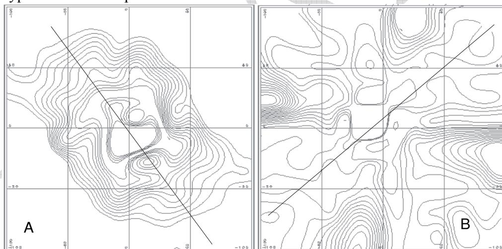
Рисунок 9.1. Пример круговой вариограммы для золоторудного месторождения. А – в горизонтальной плоскости, В – в вертикальной плоскости вдоль линии на левом чертеже. Линиями показаны направления главной структуры массива:  $AZI=325^{\circ}$ ,  $DIP=40^{\circ}$ .
