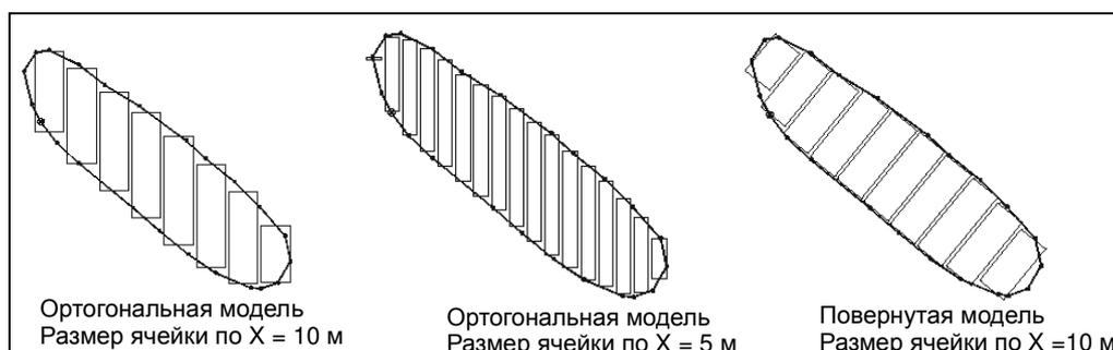
Рисунок 16.1. Три варианта заполнения контура ячейками.
