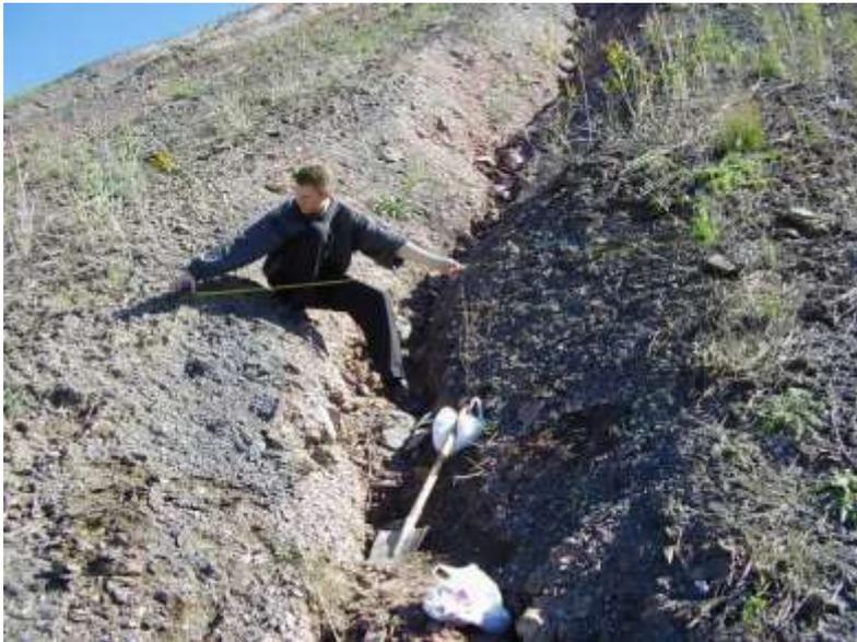
Рис. 2.24. Замеры промоины на отвале шахты «Княгининская»
