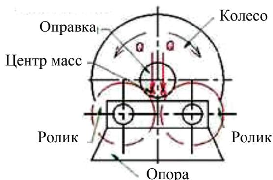
Рис. 50. Статическая балансировка на дисковых устройствах
