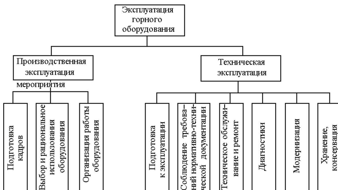
Рис. 1. Виды и структура эксплуатации горного оборудования
