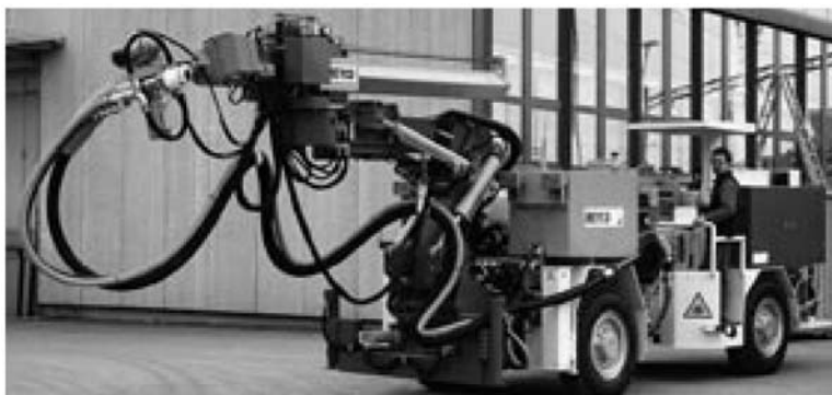
Рисунок 50: Меусо® Logica 10 как составная часть распылитель-ного оборудования Меусо® Cobra
