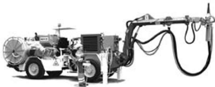
Рисунок 54: MEYCO® Cobra с манипулятором распыления MEYCO®Minima для подземных горных выработок.
