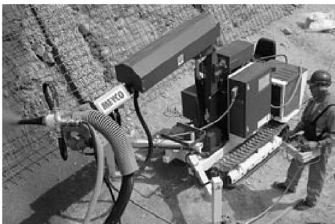
Рисунок 55: MEYCO®Oruga распылительное оборудование с 80мм высокопроизводительной системой сопла
