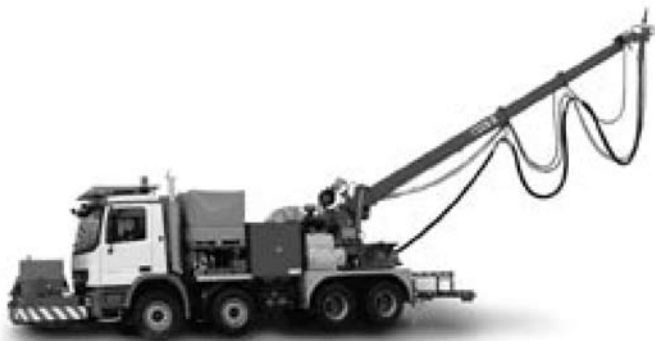
Рисунок 53: MEYCO® Roadrunner с вытянутым манипулятором распыления MEYCO® Maxima
