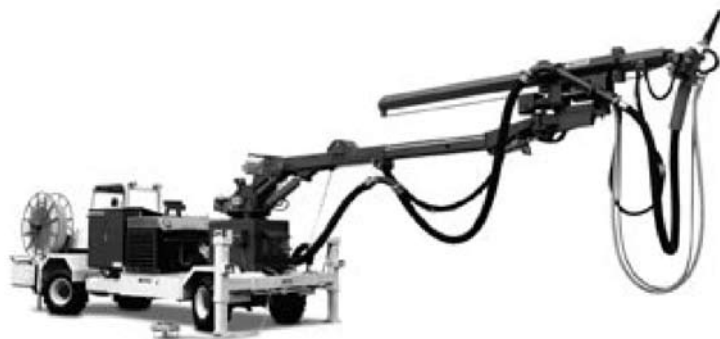
Рисунок 51: Самоходная установка набрызгбетонирования MEYCO® Potenza со встроенным манипулятором распыления MEYCO®Robojet
