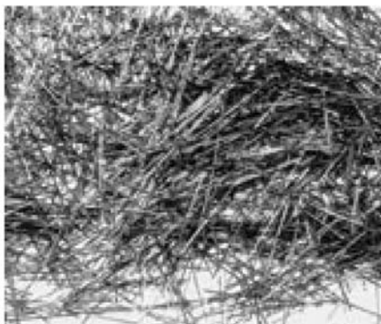
Рисунок 23: Стальные фибры, использованные для армирования набрызгбетона для крепления горных выработок
