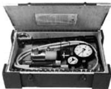
Рисунок 60: Прибор для измерения начальной прочности MEYCO® Kaindl.
