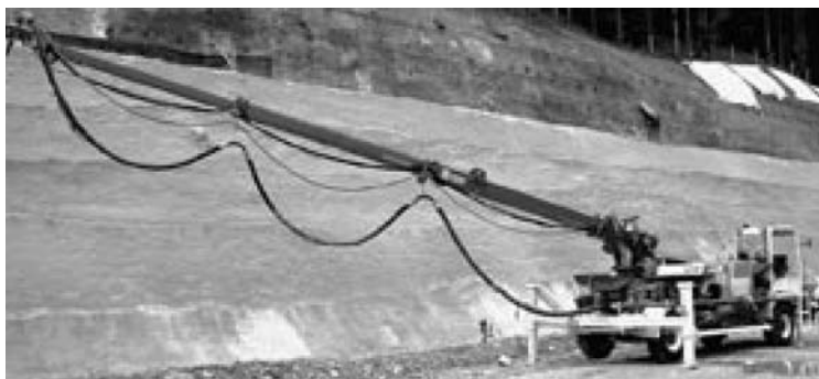
Рисунок 52: MEYCO® Potenza с вытянутым манипулятором распыления MEYCO® Maxima
