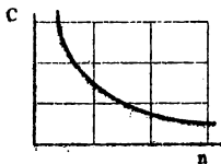
Рис. 30. Зависимость себестоимости основания под одну скважину от числа скважин в кусте
