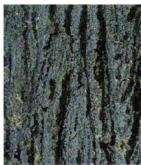
**Рис. 13. Неполнокристаллическая структура эффузивных пород с массивной текстурой**
