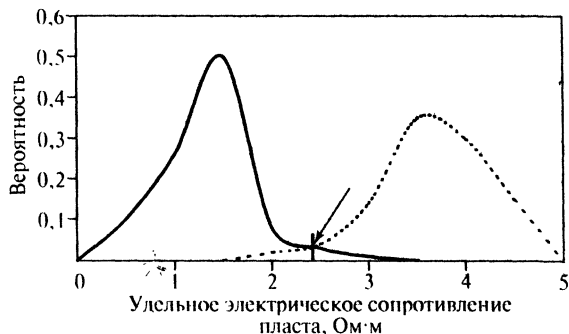
Рис 28. Распределения удельного электрического сопротивления для продуктивных (штриховая линия) и водоносных (сплошная линия) пластов. Стрелкой показано граничное (кондиционное) сопротивление r_{п\text{ кондиц}}
