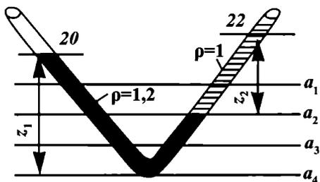
Рис. 18. Схема, иллюстрирующая выбор плоскости сравнения напорных минерализованных и пресных вод в прогнутом пласте (по А.И. Силину-Бекчурину)
