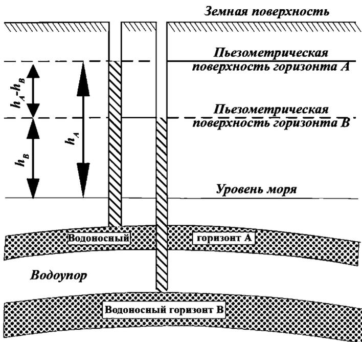
Рис. 63. Схема соотношений водоносных горизонтов с различными напорами для оценки условий хранения газов и жидкостей и захоронения промышленных стоков в водоносных пластах
