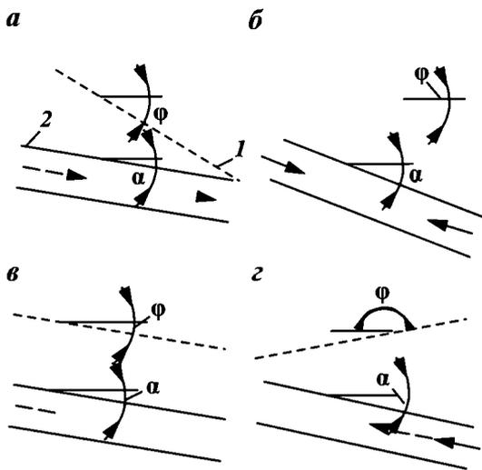
Рис. 48. Соотношения наклонов пьезометрической и структурной поверхностей, определяющие различные условия миграции УВ по пласту-коллектору (по А.А. Плотникову): 1 – пьезометрическая поверхность; 2 – кровля пласта-коллектора
