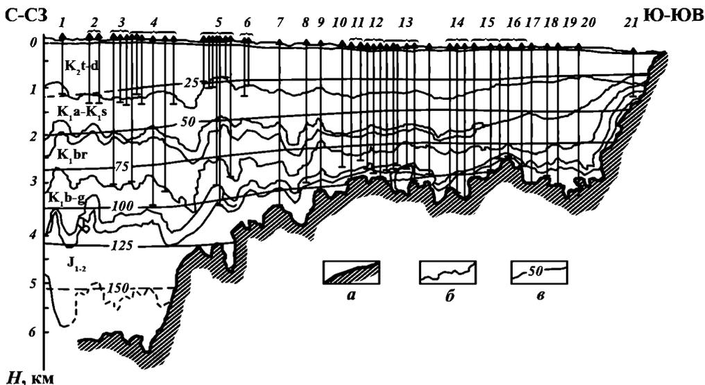
Рис. 31. Кривые распределения температур горных пород в меридиональном геологическом разрезе Западно-Сибирского бассейна (по А.Р. Курникову, Б.П. Ставникову). Границы: *a* – поверхности фундамента; *b* – разновозрастных отложений; *v* – линий равных температур, °С.
