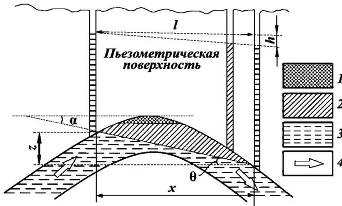
Рис. 45. Схема зависимости между наклоном нефтеводяного контакта и пьезометрической поверхностью (по А.И. Леворсену, с изменениями):
