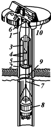
**Рис. 32. Пьезограф В.П. Яковлева, установленный на устье скважины:**
