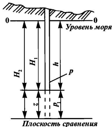
Рис. 19. Схематическое изображение приведения напоров к плоскости сравнения (по В.В. Ягодину)
