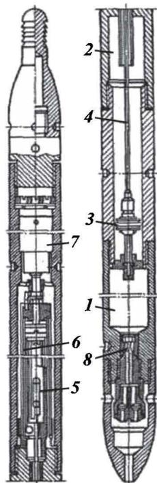
**Рис. 36. Самопишущий глубинный дифференциальный манометр ДГМ-4 конструкции И.М. Иванова:**
