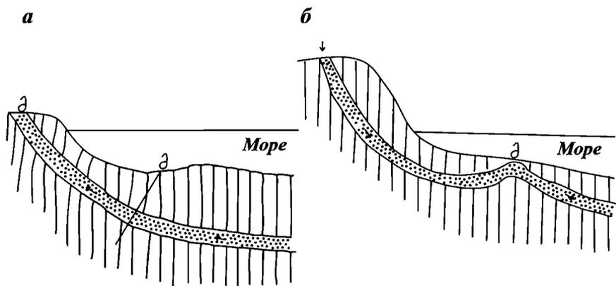
**Рис. 6.** Схема образования субмаринных источников.
