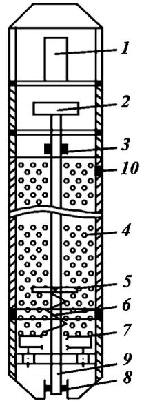
**Рис. 34. Пробоотборник фирмы «Кастер»**
