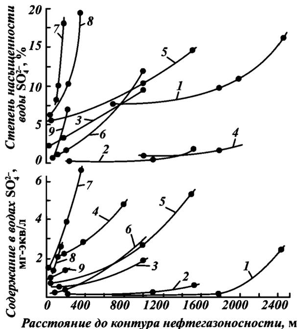
Рис. 55. Кривые изменения сульфатного показателя в пластовых водах Нижнего Поволжья по мере удаления от контура нефтегазоносности (по Е.В. Стаднику; для оценки сульфонасыщенности использован специальный коэффициент 10800/Са).
