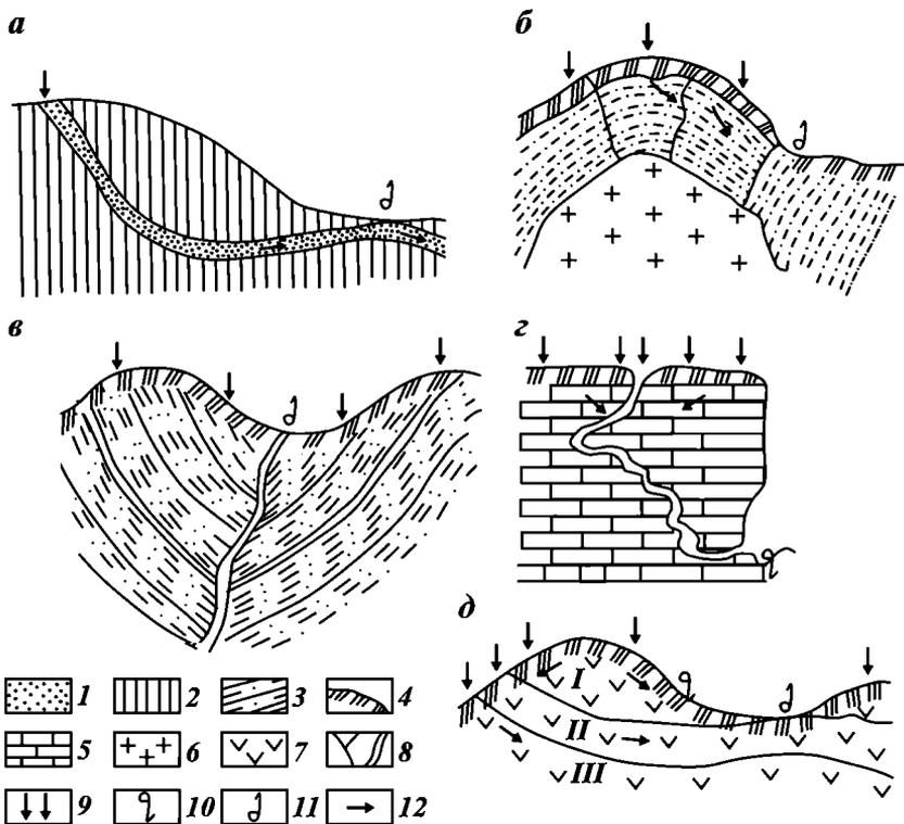
**Рис. 3. Схема условий разгрузки вод и образования источников.**
