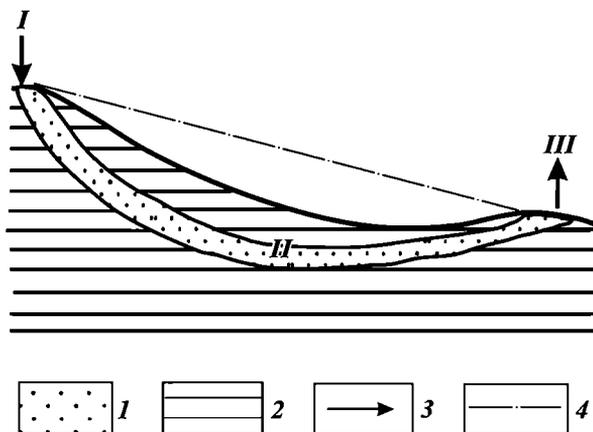
Рис. 26. Схема инфильтрационной водонапорной системы:
