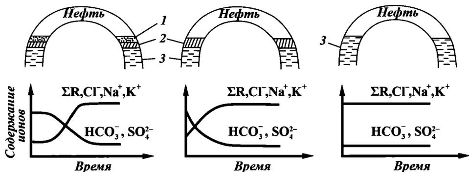
Рис. 57. Схемы распределения различных типов вод под нефтяными залежами и графики изменения химического состава этих вод во времени при разработке (по А.М. Никанорову).
