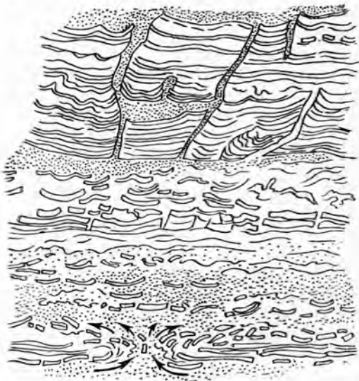
Рис. 7. Следы выдавливания песчаного осадка из нижнего слоя в верхний через прослой уплотнившегося алевролита, трещины усыхания и глинистые черепки в пестроцветных алевролитах, переслаивающихся с песчаниками, в верхней части сумурлинской свиты. Верховья р. Сумуру, правый склон долины. \frac{1}{2}
