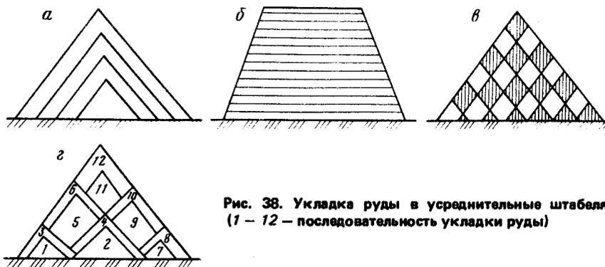
Рис. 38. Укладка руды в усреднительные штабели (1 – 12 – последовательность укладки руды)
