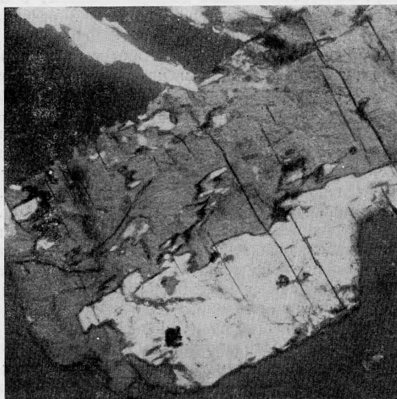
Рис. 6. «Шахматный» тип двойникования в гомогенных калишпатах из пегматита в меланократовых науянитах. Участки с двойниковыми индивидами, имитирующими альбитовые двойники роста. Обр. 376-2, увел. 46, николи +. Разрез \perp [100]
