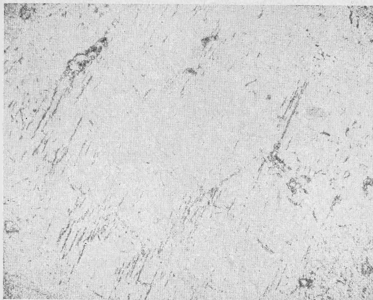
Рис. 3. Трещины спайности минерала, замещенного гидрогроссуляром. Увел. 18, один николь
