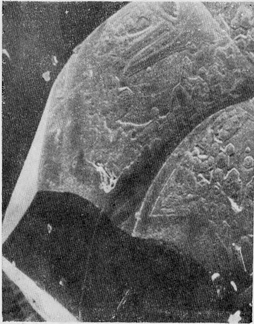
Рис. 3. Общая морфология бугристой базисной поверхности кристалла кварца. Увел. 100
