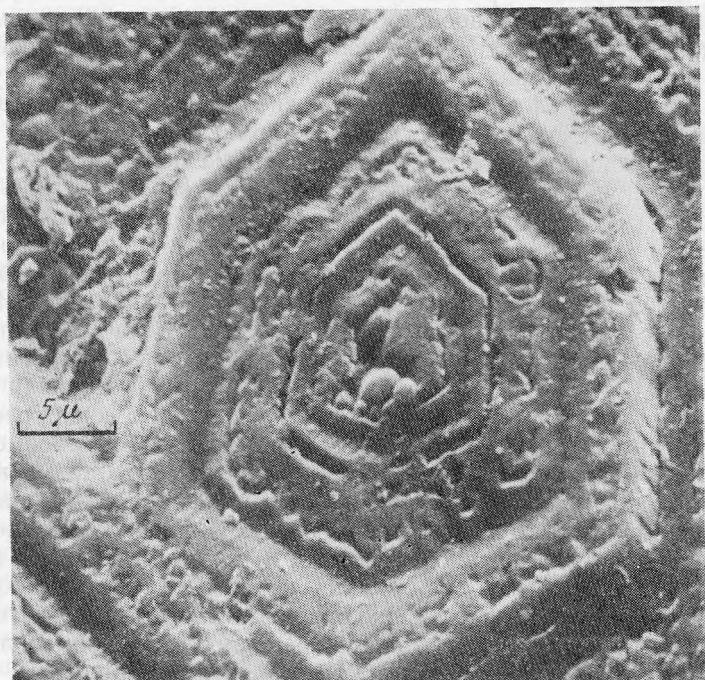
Рис. 8. Четко проявленная футлярная форма растворения, содержащая центральный канал
