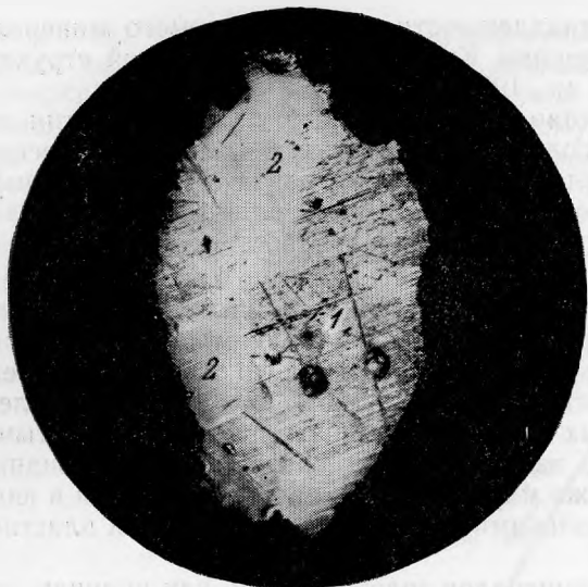
Рис. 2. Сросток палладисто-родистого аргентокупроаурита (1) с поляритом — Pd(Pb, Bi) (2) Цементный полированный шлиф. Запрессовано в полистироле. Увел. 600
