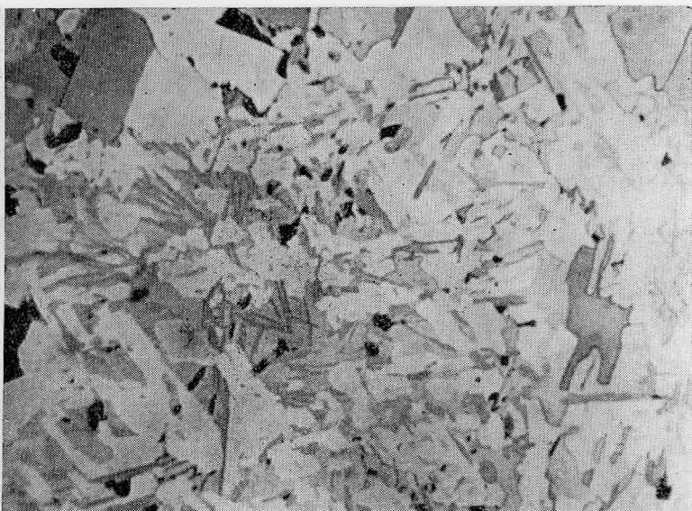
Рис. 10. Решетчатая структура сростания гудмундита (белое), пирротина (темно-серое) и галенита (серое), образующаяся при замещении джемсонита. Увел. 320
