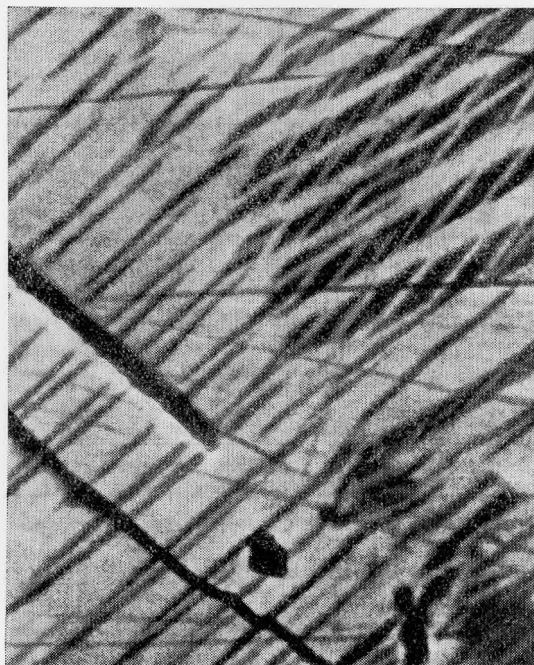
Рис. 1. Тонкопластинчатая структура сростаний андорита (темно-серое) и минерала состава \text{AgPb}_2\text{Sb}_3\text{S}_7 (светло-серое) в образце рамдорита из Потоси. Снято в обратнорассеянных электронах на микрозонде. Увел. 960
