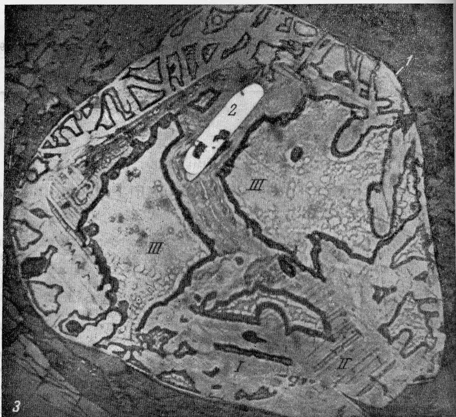
Рис. 1. Агрегатное строение псевдокристаллов метамиктного циркона I ), расположенного среди хрупких минералов; 2 — молибденит; 3 — полевои шпат. Микрофото протравленного в HF полированного шлифа. Увел. 900
