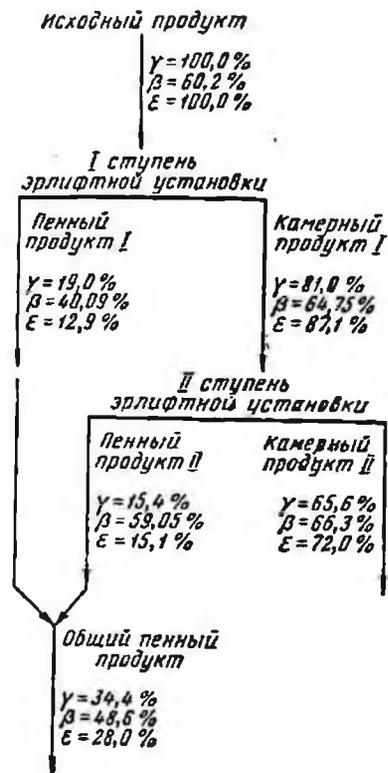
Рис. 36. Качественно-количественная схема обратной флотации магнетитового концентрата на эрлифтной установке
