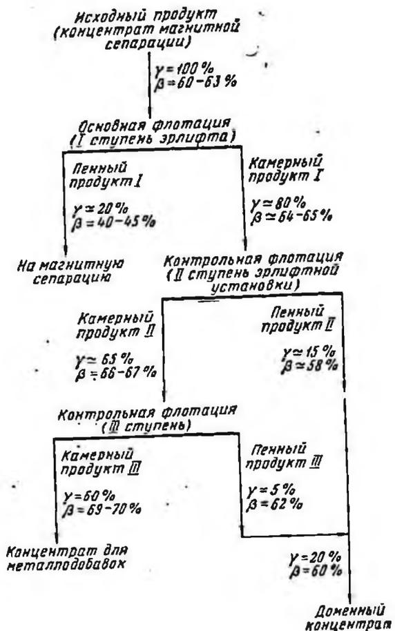
Рис. 37. Схема обратной флотации магнетитового концентрата на эрлифтной установке
