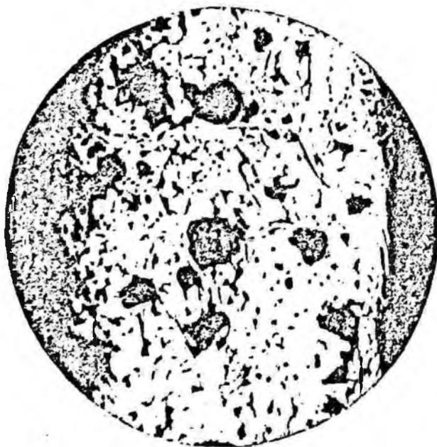
Рис. 89. Микроструктура реликтов магнетита (серое), уцелевших от замещения гематитом (белое), в опытном агломерате с повышенной пористостью (черное — поры). Отраженный свет,  $\times 70$
