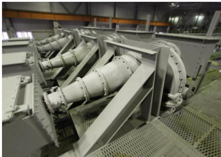
Рис. 9.7. Низконапорные гидроциклоны большого диаметра и производительности
