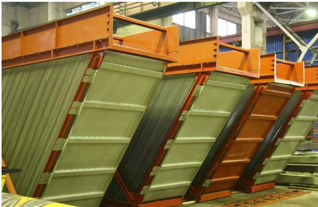
Рис. 11.12. Пластинчатые модули тонкослойных сгустителей
