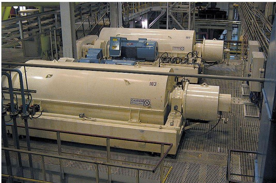
Рис. 8.7. Общий вид осадительно-фильтрующих центрифуг «Декантер»
