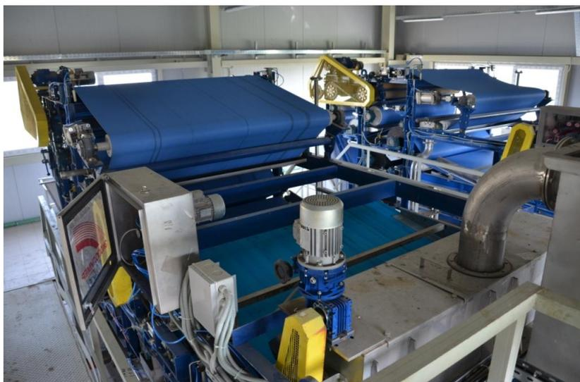
Рис. 6.11. Общий вид ленточного фильтр-пресса ЭПФ-Л
