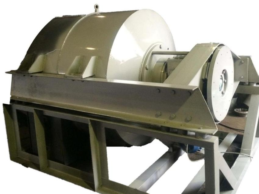
Рис. 7.9. Общий вид вибрационной центрифуги ФГВ
