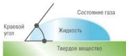
Рис. 83. Образование краевого угла смачивания
