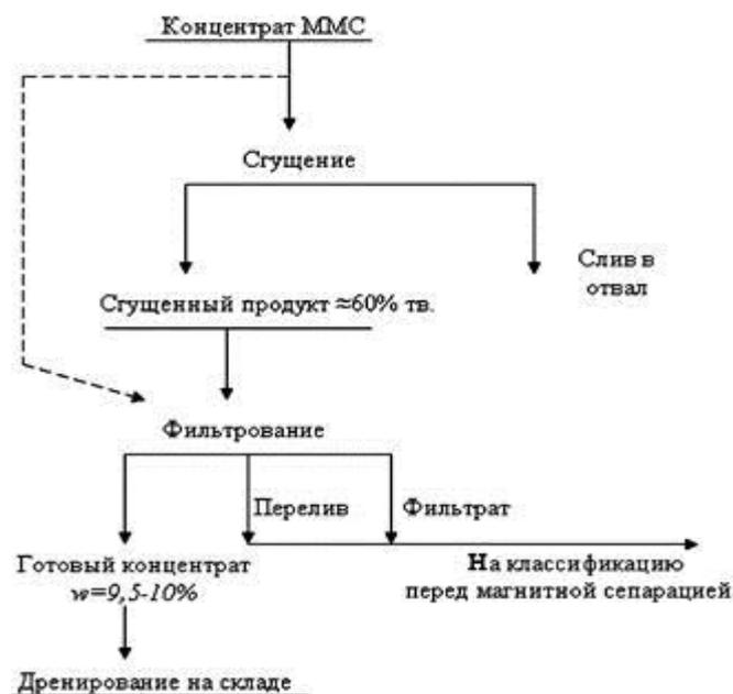
Рис. 128. Схема обезвоживания магнетитового концентрата
