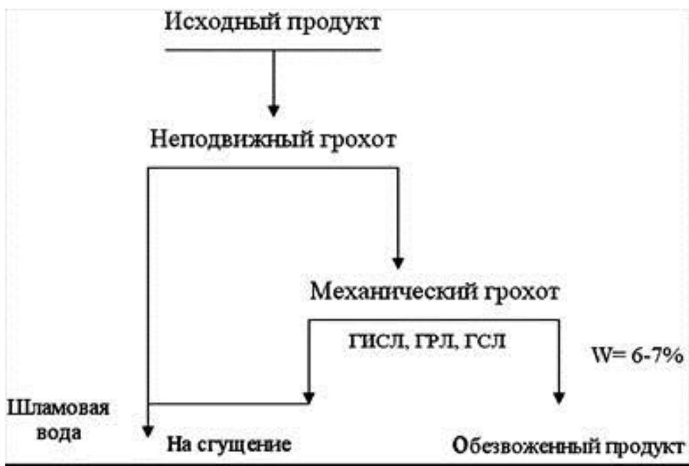
Рис. 126. Схема обезвоживания крупного продукта
