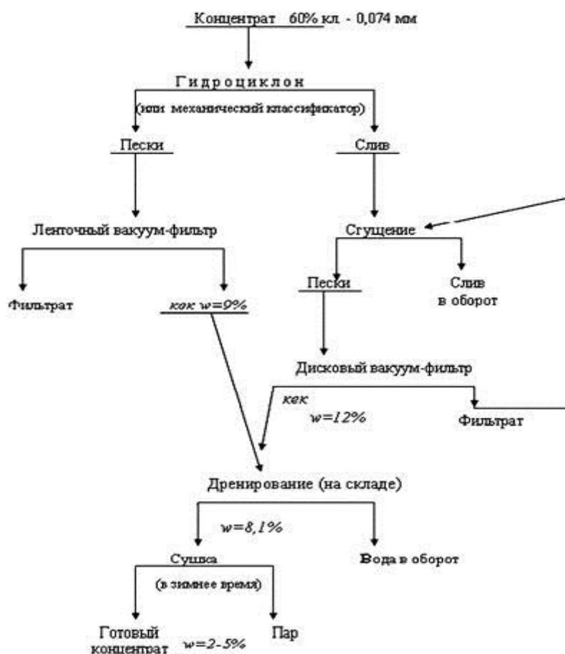
Рис. 127. Схема обезвоживания мелкозернистого магнетитового концентрата
