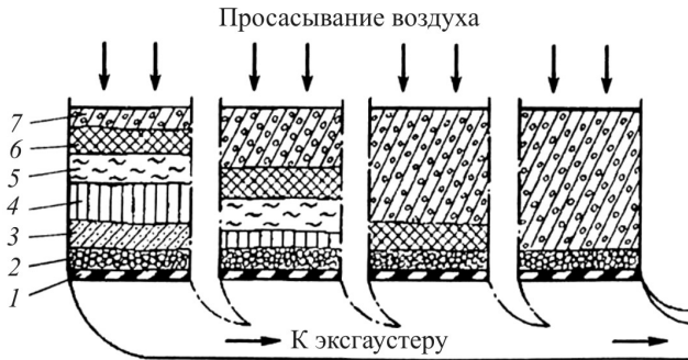
Рис. 81. Схема процесса агломерации: 1 – колосниковая решетка; 2 – постель; 3 – зона переувлажнения; 4 – зона сушки; 5 – зона нагрева шихты; 6 – зона горения; 7 – зона готового агломерата
