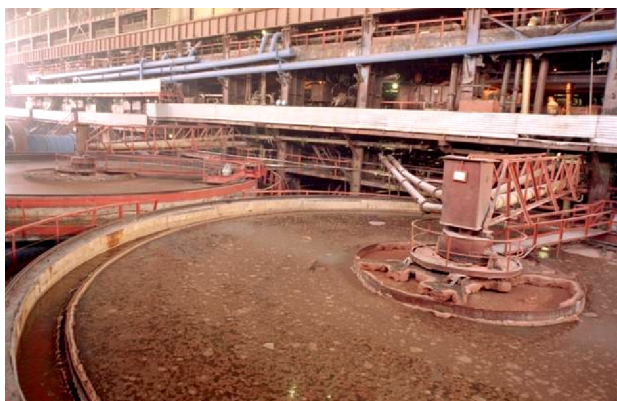
Рис. 86. Внешний вид радиального сгустителя
