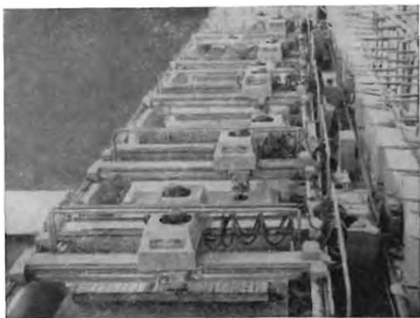
Рис. 59. Линия из спаренных шлифовально-полировальных мостовых станков модели «Минали МС-3» фирмы «Минали»
