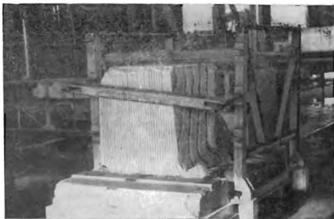
Рис. 57. Крепление мраморного блока на станочной тележке с помощью перекидных винтовых захватов
