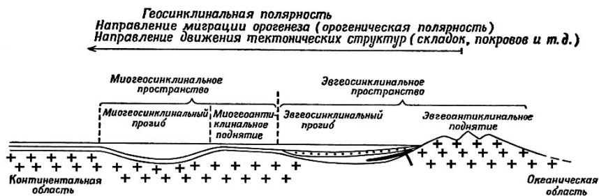
Рис. 121. Принципиальная схема элементарной пары эвгеосинклиналь – миогеосинклиналь (по Ж.Обуэну)
